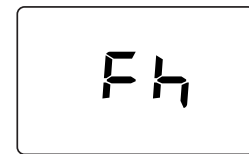
рис. 7- Выпуск воздуха с выключенным вентилятором
