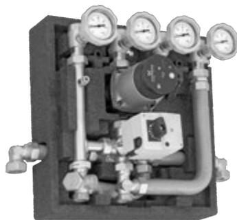
Condix – специально разработан для повышения КПД конденсационного котла. Компактный насосный модуль распределяет мощность котла на контуры радиаторного отопления, теплого пола и загрузку бойлера ГВС по приоритету. Смесительный клапан под управлением интеллектуальной системы автоматики направляют в смесительный контур, охлажденный после прямого контура теплоноситель.
