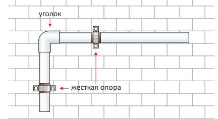
Крепление при разведении углом
