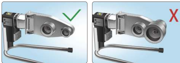
Правильное крепление нагревательных насадок
