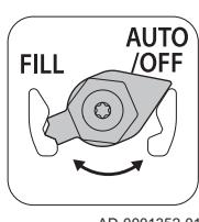
4. Установить устройство подпитки или устройство автоматической подпитки на OFF, когда будет достигнуто требуемое давление воды.
