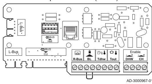
Рис.27 Подключение модулирующего термостата
