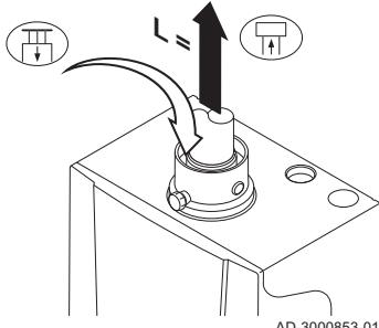
Длина канала отвода дымовых газов до кровельной проходки
