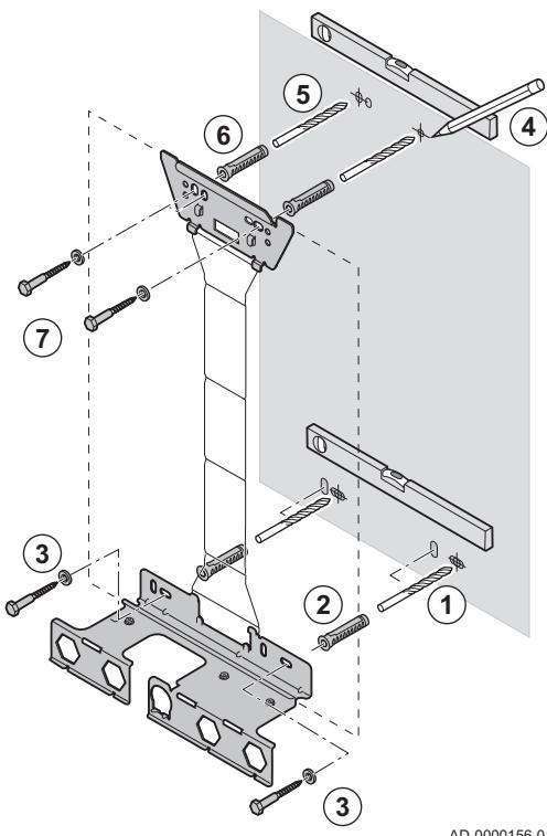
Рис.16 Удлинение монтажной рамы
