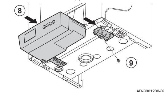
Рис.26 Стандартная управляющая электронная плата (СВ-06)
