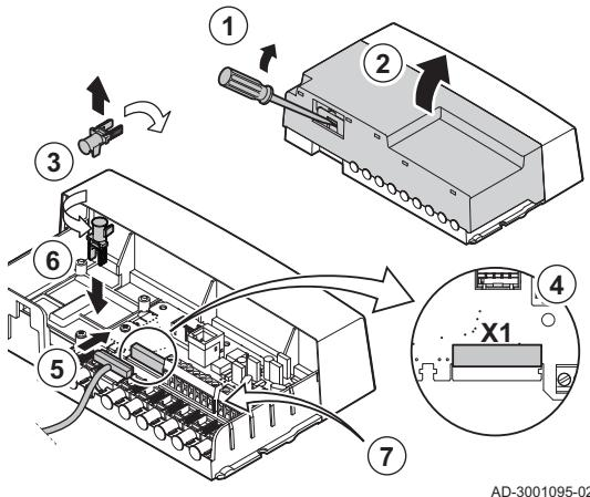
Рис.25 Монтаж соединительного блока
