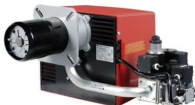
Bruciatori di gas monostadio a basse emissioni inquinanti certificati CE 676 classe (NO<sub>x</sub><80 mg/kWh – CO<60mg/kWh), scocca in alluminio, ventilatore ad elevata prevalenza, testa di combustione ad elevata stabilità di fiamma, cofano di protezione insonorizzato.
