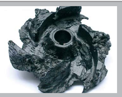
Коррозия разрушает детали насоса
