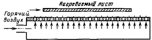
Рис. 9.3. Схема термообработки листовых изделий на «воздушной подушке»
