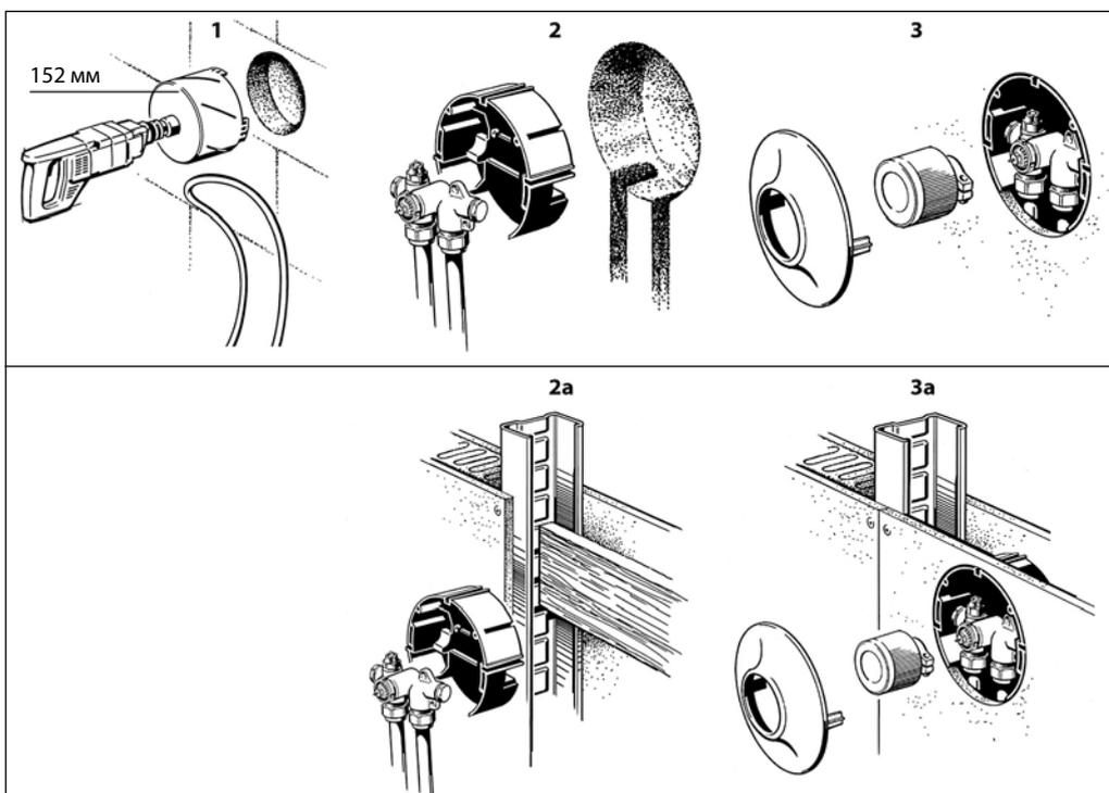
Клапаны FHV одинаково подходят для монтажа как на несущих стенах, так и на перегородках. Для удобства монтажа регулирующих клапанов FHV служит компактная настенная коробка для размещения корпуса клапана, которая может быть смонтирована и закреплена в полый нише в стене любого типа. Все присоединения выполняют внутри корпуса. Термоэлемент монтируют после установки клапана.
