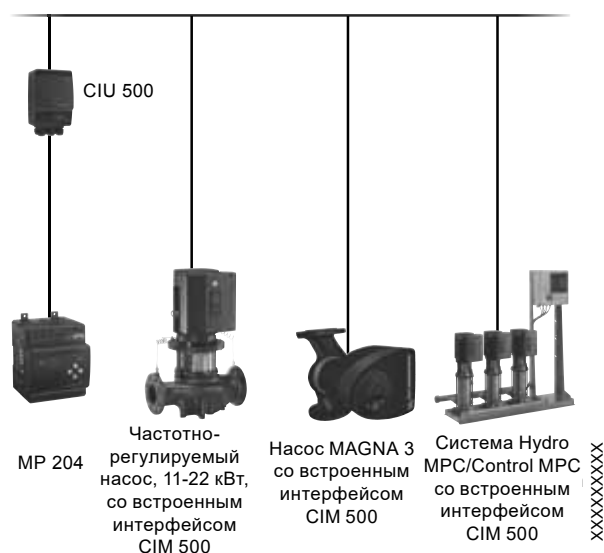
Рис. 136 CIM/CIU 500 в сети PROFINET IO
