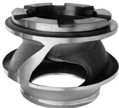
Рис. 23 Двухканальное рабочее колесо S-2 фирмы GRUNDFOS. Надежное противостояние засорению получено за счет установки удлинённых лопастей и диагональной конструкции рабочего колеса. Симметричная конструкция сбалансирована изначально.
