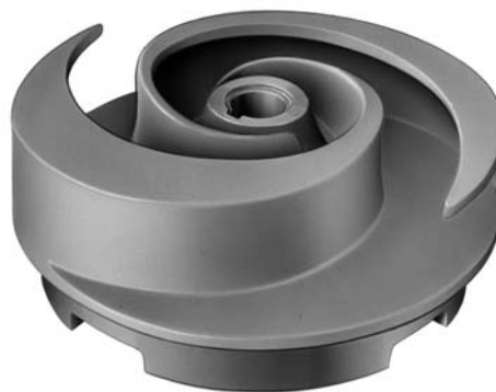
Рис. 24 Рабочее колесо SuperVortex, разработанное фирмой GRUNDFOS. Разработка включает патентованные концевые крылышки на лопастях, которые предотвращают образование на кромках лопаток вторичных вихрей, значительно повышая КПД насоса.
