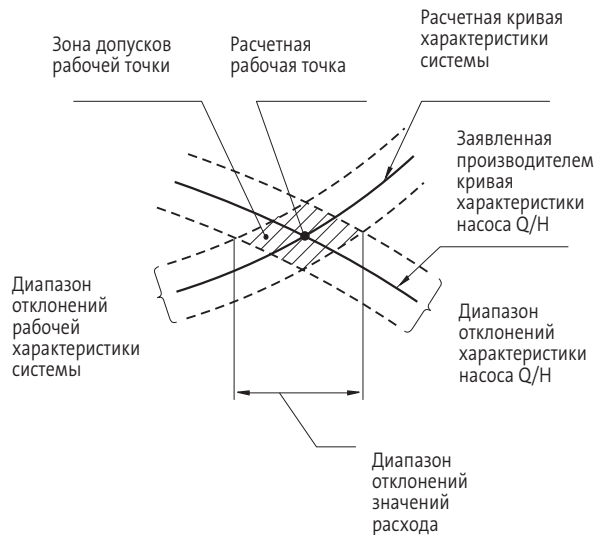
Рис. 63 Диапазон допусков для рабочей точки. Реальная рабочая точка для насосной установки может находиться внутри заштрихованной области, ограниченной кривыми допускаемых отклонений по рабочим характеристикам насоса и системы. Расход насоса Q может изменяться в широких пределах.
