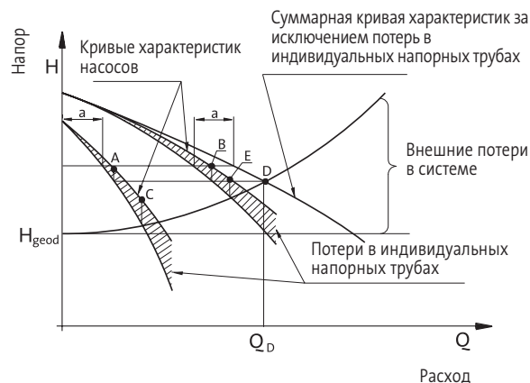
Рис. 62 Рабочие точки двух различных насосов, подсоединенных к единой системе. Потери в индивидуальных напорных трубах насосов вычтены из напоров насосов и изображены в масштабе на диаграмме. Суммарная кривая характеристик насосов получена путем использования кривых с пониженными напорами, и ее пересечение с рабочей кривой характеристики системы дает рабочую точку совместной эксплуатации (D). Рабочие точки каждого из насосов являются точки A и B. Точки C и E соответствуют рабочим точкам насосов, работающих по отдельности.
