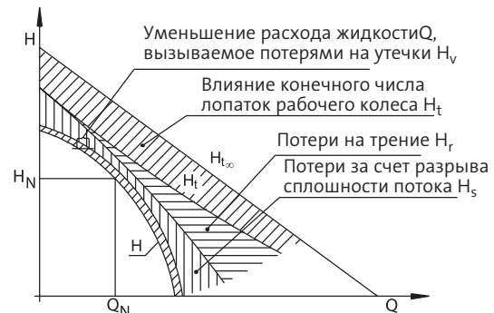
Рис. 4 Уменьшение характеристики Q/H ( H ) насоса по сравнению с теоретическим напором насоса H_{т\infty} .
