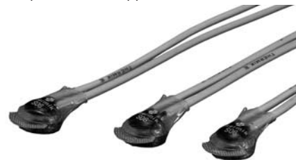
Рис. 41 Термовыключатель. Устройство состоит из биметаллического микровыключателя, который размыкает цепь в соответствии с заданной температурой. Выключатель подсоединен к панели управления, чтобы разомкнуть цепь питания двигателя в случае его перегрева.
