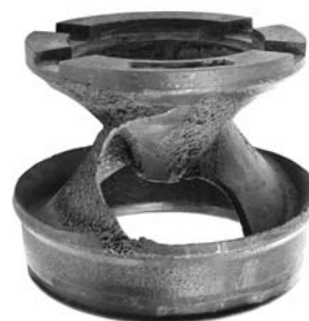
Рис. 8 Типичные следы разрушения материала рабочего колеса вследствие кавитации
