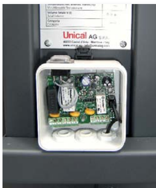
■ Система регулирования температуры, с датчиком NTC
