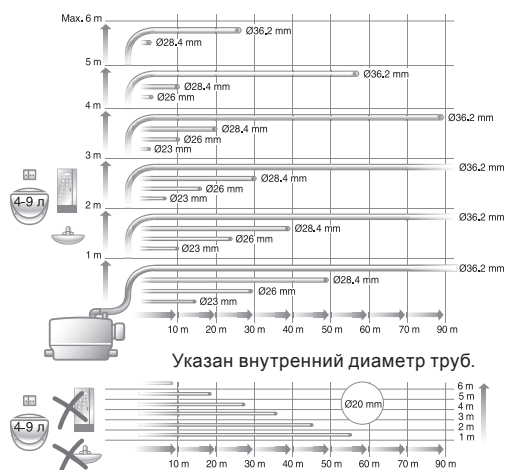
Рис. 58 Максимальная длина вертикальных и горизонтальных сливных труб
