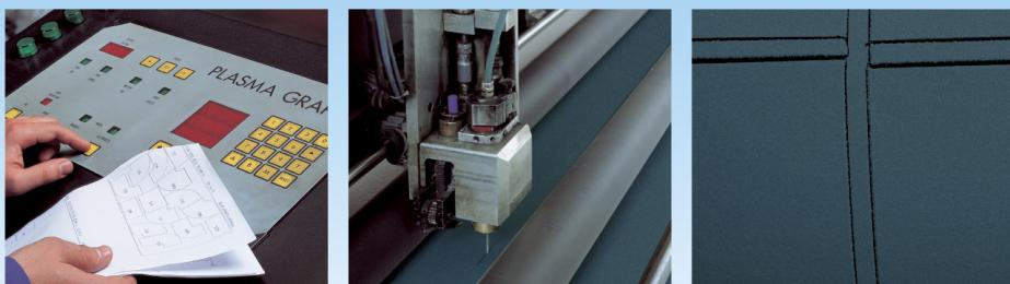
Предварительно выкроенные на заводе куски изоляционного материала “K-FLEX” ST 1500 mm позволяют быстро и качественно выполнять монтаж изоляции на воздуховодах.
