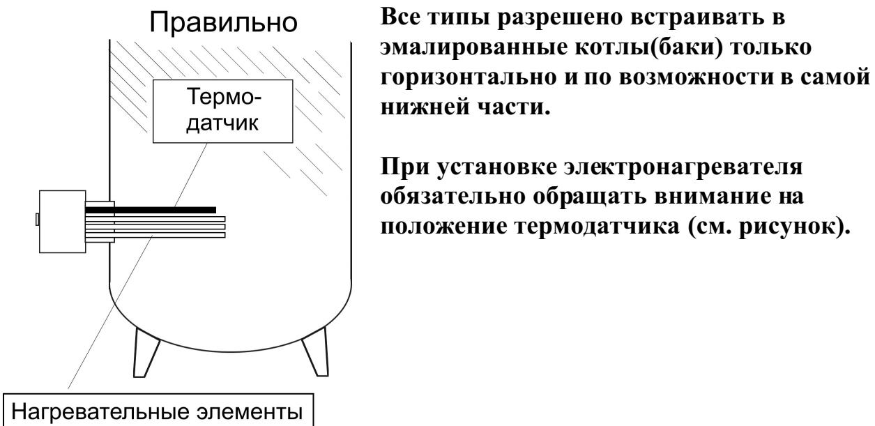
Фланцевый нагревательный элемент должен быть встроен горизонтально в нижнюю часть эмалированного котла. Рамка для фланца не должна быть длиннее чем 75 мм, чтобы обеспечивать достаточную глубину погружения нагревательных
