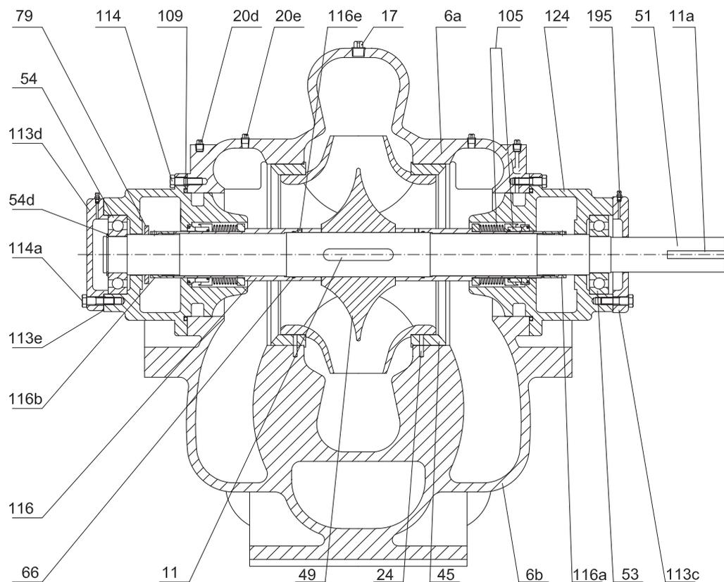
Рис. 27 Вид в разрезе, опциональное исполнение 10
