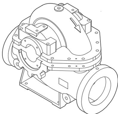
Рис. 33 Верхняя и нижняя части корпуса насоса LS
