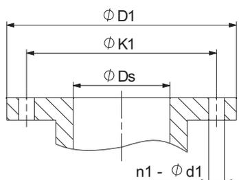
Рис. 45 Всасывающий фланец
