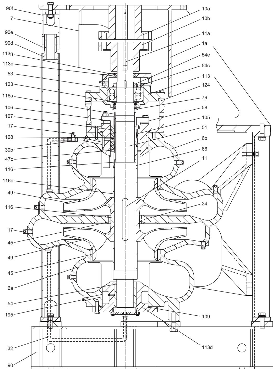
Рис. 26 Вид в разрезе, стандартный тип исполнения 17
