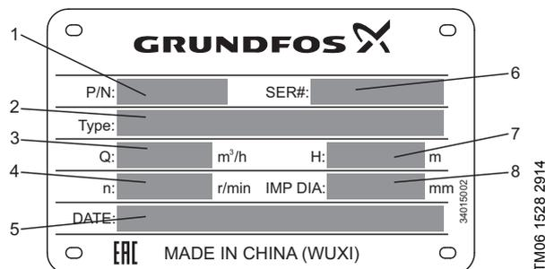
Рис. 15 Фирменная табличка насоса LS
