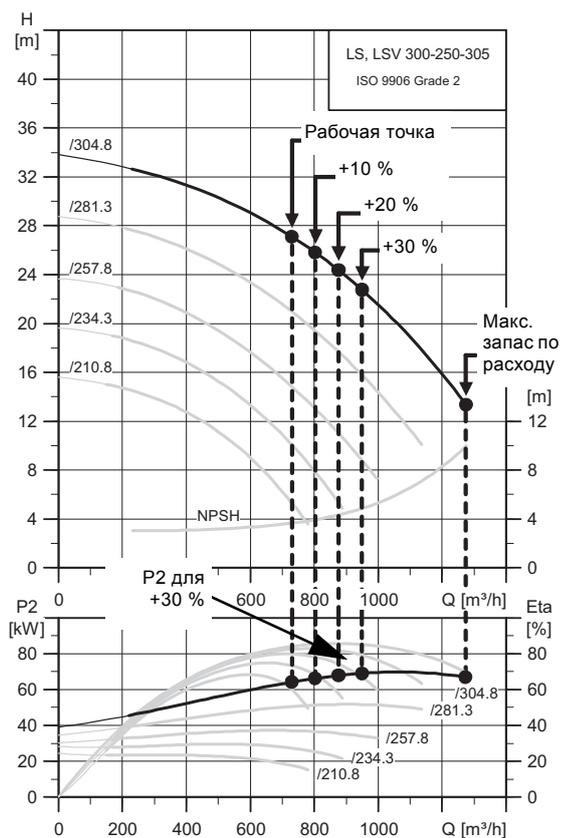
Рис. 42 Определение P2 для выбранного запаса по расходу 30 %
