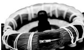
Рис. 21 Датчик РТС, встроенный в обмотку
