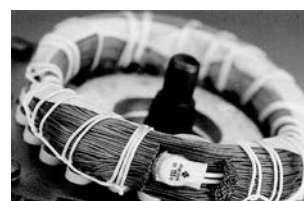
Рис. 23 Термовыключатель, встроенный в обмотку электродвигателя
