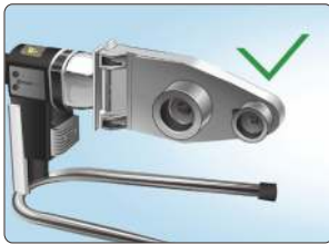
Правильное крепление нагревательных насадок
