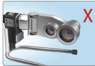
Неправильное крепление нагревательных насадок
