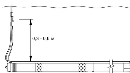
Рис. 5 Горизонтальный монтаж
