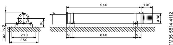
Рис. 33 Кожух охлаждения и сетчатый фильтр для SQF 3"
