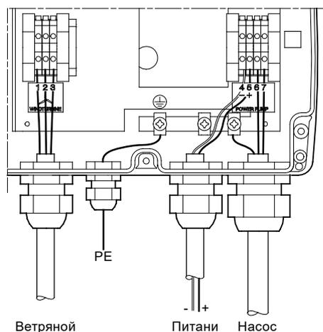
Рис. 26 Электрические подключения, IO 102
