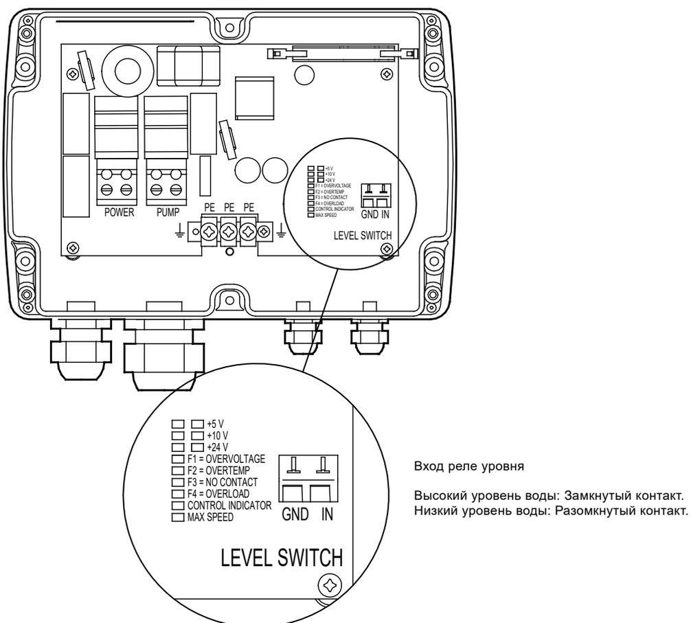
Рис. 20 Электрические соединения, CU 200
