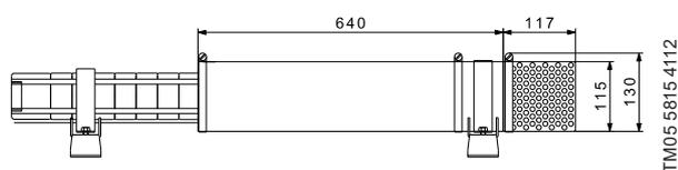
Рис. 34 Кожух охлаждения и сетчатый фильтр для SQF 4"
